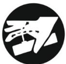
Es ist strengstens untersagt, flexible Schläuche in der Hand zu halten. Im Falle einer Beschädigung kann Schmiermittel unter die Haut eindringen.
